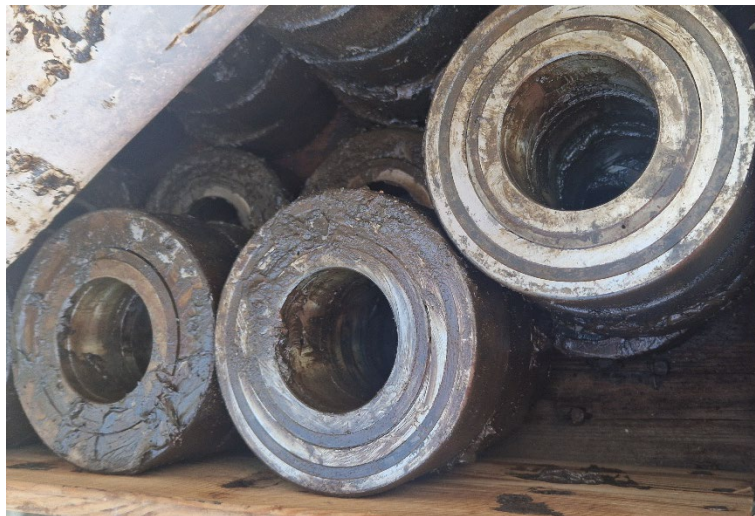
Imagem 2: rolamentos de rolos cilíndricos em aço carga radial/axial INA 121948 e arruelas em aço coflexip E24-1
